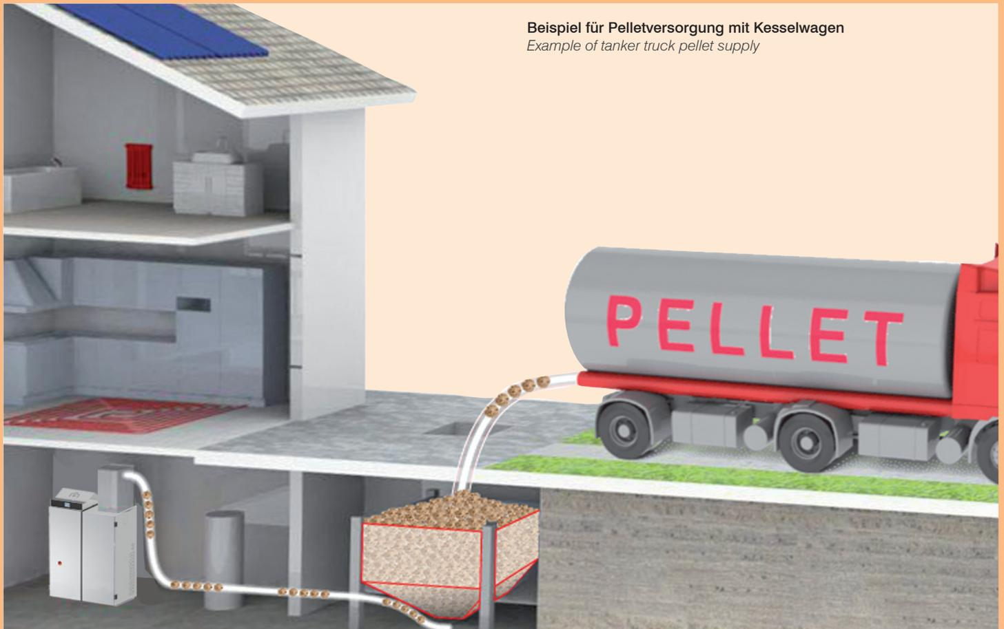
**Beispiel für Pelletversorgung mit Kesselwagen**
